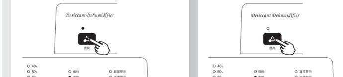
注意：机器关机后在四分钟延迟运行结束后，机器导风板会自动往下关闭。
