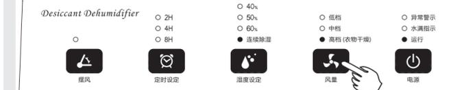
注意：请注意在风量设置为高档时，机器默认湿度设置为连续除湿状态，连续除湿指示灯会点亮，此时机器无法进行湿度设定键的转换。
