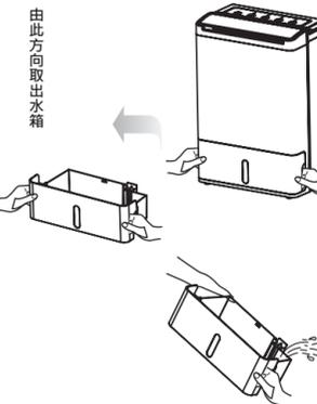
3 放回水箱, 机器将按水满前的状态重新启动工作 (达 3 分钟后, 除湿功能才会启动)
